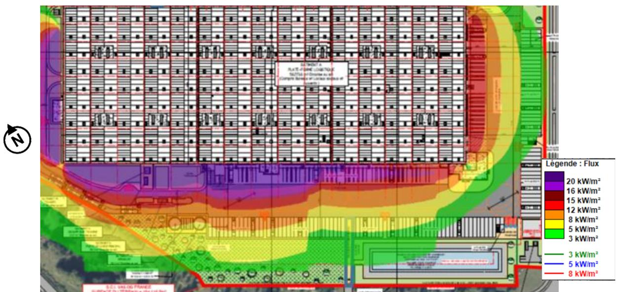
Figure 6-8 : Flux issus d'un incendie de stockage 2662 au niveau des parois Sud et Est
