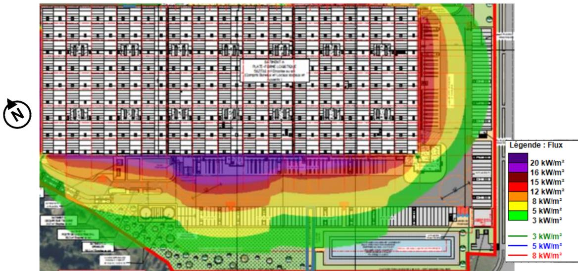
Figure 6-10 : Flux issus d'un incendie de stockage 2662 au niveau des parois Sud et Est
