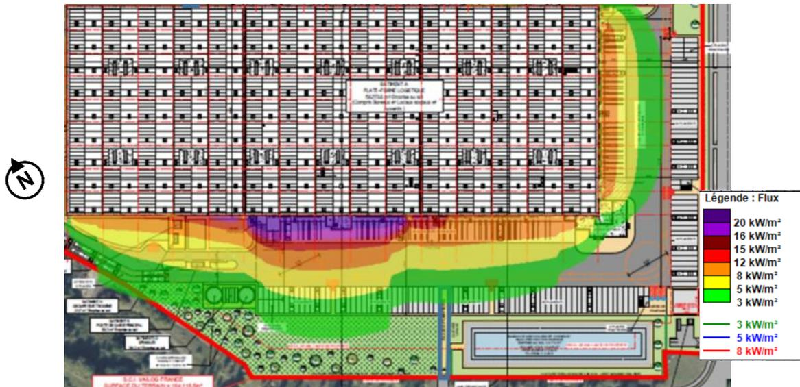
Figure 6-9 : Flux issus d'un incendie de stockage 1510 au niveau des parois Sud et Est
